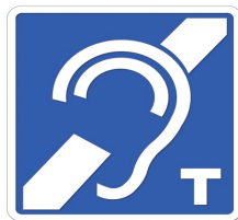
Rys. Oznaczenie miejsc z funkcjonowaniem pętli indukcyjnej piktogramem zgodnym z ETSI EN 301 4622 (2000-03)
